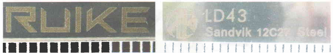
Зображення 5. Збільшений вигляд маркувань на клинку ножа.
